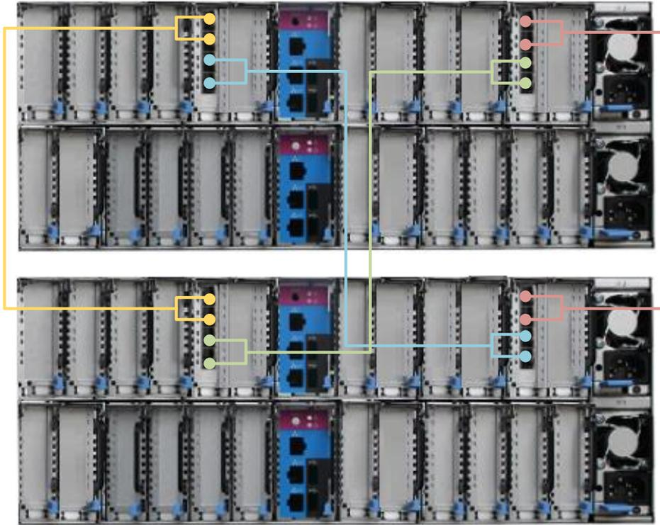
图 5-3 NTB 卡四控连接（单端口线缆方式）
